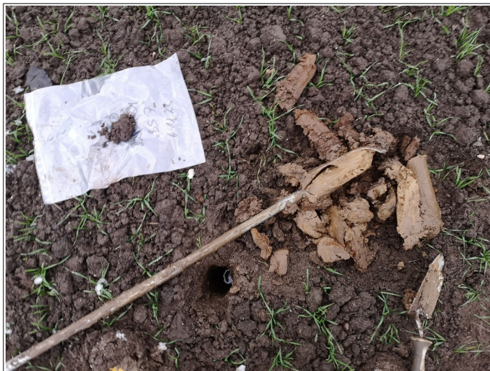
Abbildung 16: Bohransatzpunkt BS 7 mit Bodenaushub, GW im Bohrloch
