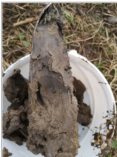
Abbildung 16: Bohransatzpunkt BS 7 mit Bodenaushub, GW im Bohrloch
