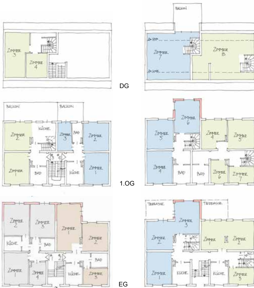
Abb. 7.1.2: Grundrissbeispiele Neuorganisation der Wohneinheiten (Testentwurf basierend auf Haustyp B - siehe B5.3.2)
